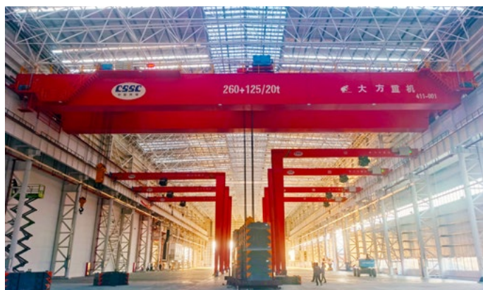
服务于中船第九设计研究院工程有限公司的 QDX260t+125t 新中式双梁起重机 China Shipbuilding Ninth Design and Research Institute Engineering Co., Ltd., QDX260t+125t new Chinese double beam crane
