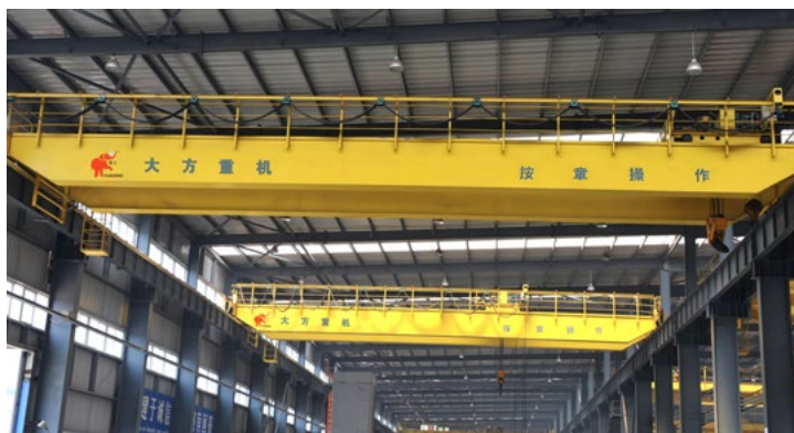
服务于安徽江淮汽车股份有限公司的批量 双梁起重机 Batch double girder cranes serving Anhui Jianghuai Automobile Co., Ltd.
