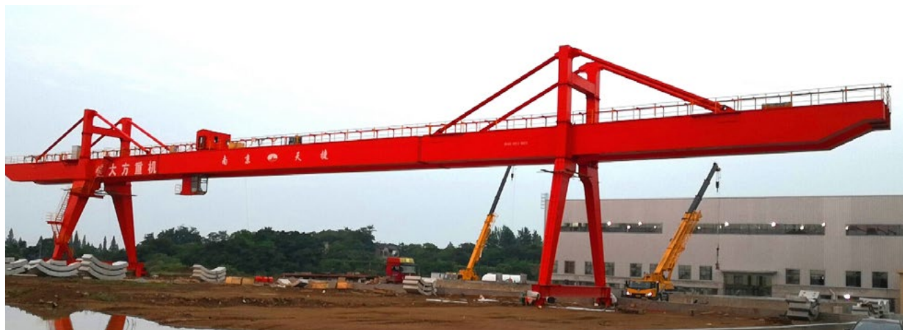
总长 100m 超长跨度双主梁门式起重机 Total length 100m super long span double main girder gantry crane
