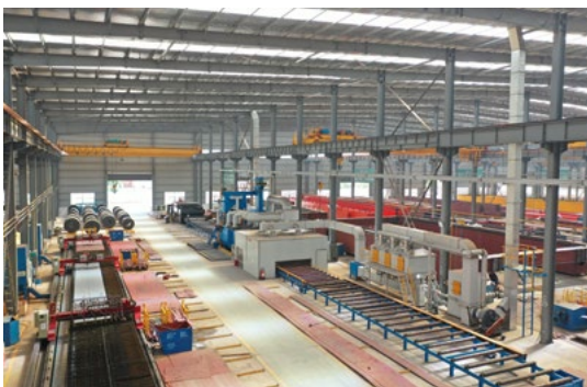
全自动钢材预处理生产线（开平、抛丸、底漆烘干）
